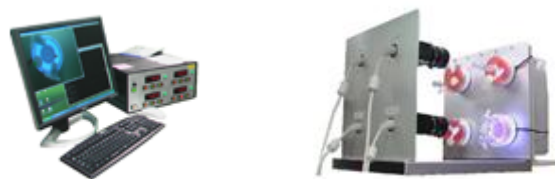
図1 自動回転制御システム(左) RWV バイオリアクター(右)
