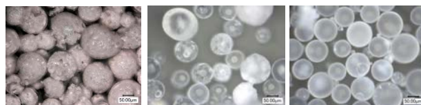
(a) 原料 (b) 多相アーク処理 (c) ハイブリッド処理 Fig.3 粒子の外観 (処理粒子は42~45 J/g の条件)
