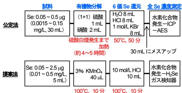
図1 セレンの測定システムの概要
