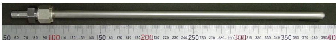
図1 外径10 mm×長さ300 mmの触媒一体化モジュール
