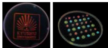
Fig.3 線発光、点発光透明ガラス
