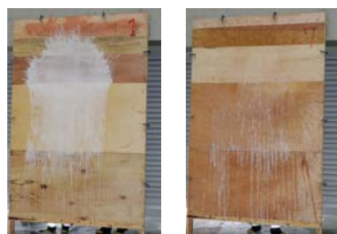
(a) 新型ノズル (b) 現行ノズル 図 1 壁面への CAF の付着状況
